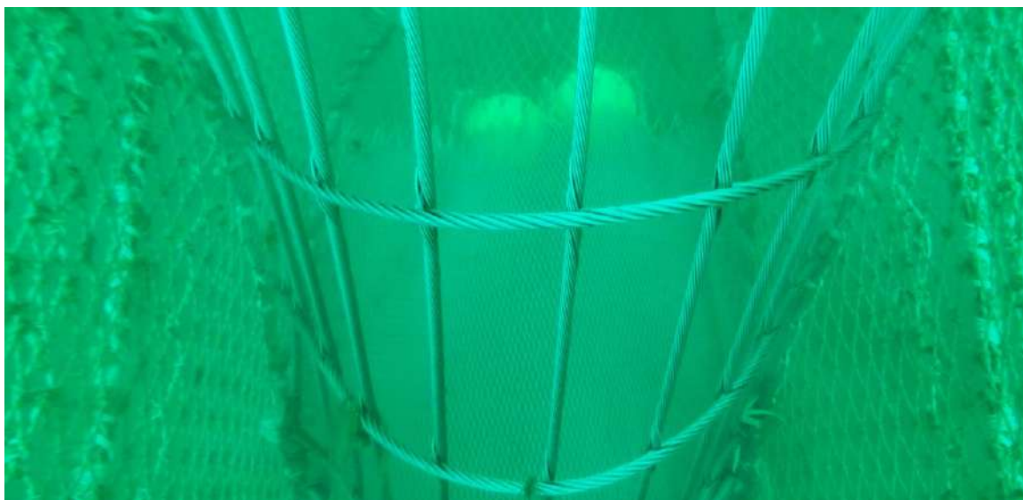
Figuur 3. Flexibele TED voor de vistrawlvisserij
